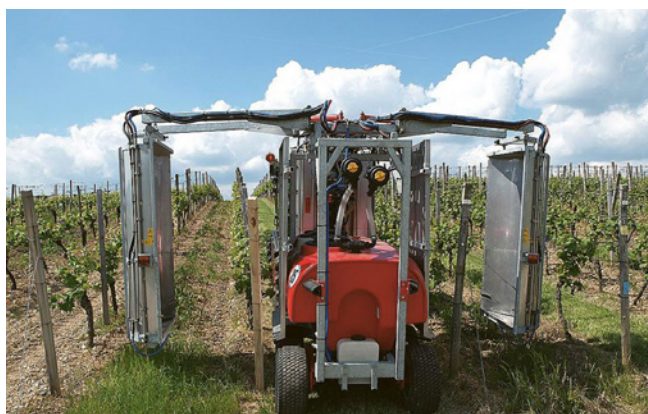
Pulvérisateur sous tunnel; source : Hans Wanner GmbH
